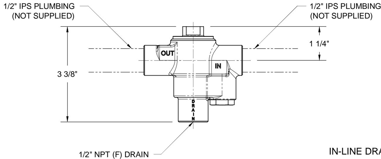
IN-LINE DRAIN INSTALLATION SHOWN
