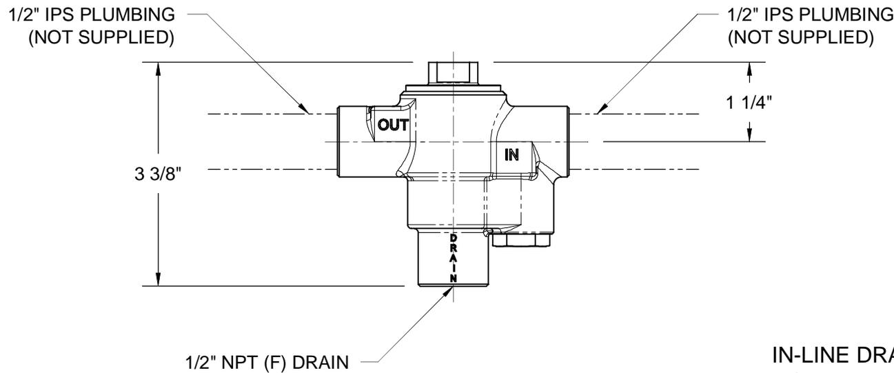
IN-LINE DRAIN INSTALLATION SHOWN
